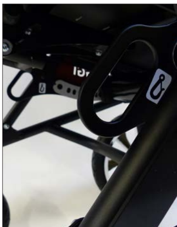
Befestigungspunkte, vorne nach ISO 7176-19
